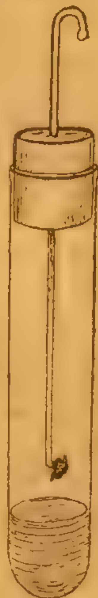
Рис. 9. Проба признаковъ разложенія мяса реактивомъ Eber'a.
